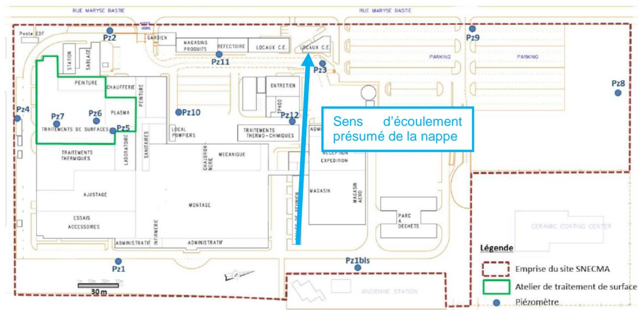
**Figure 41 : Plan d'implantation des piézomètres (source Antéa)**
